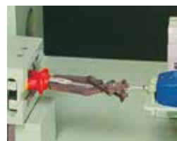
Test wytrzymałości mechanicznej rekojeści. Handles mechanical resistance test.
